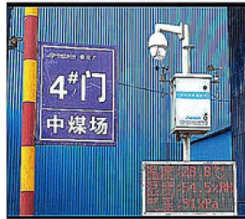
原料棚出入扬尘监测监控
