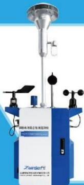
采用β射线法，实时监测大气中PM2.5、PM10、TSP微粒浓度，模块化设计，能够适应复杂环境，具备电子兼容A级设计，以及IP65防尘、防水设计，功能完善、体积小巧、系统集成度高、坚固耐用，应用于建筑工地、厂矿企业、物料堆场、城市道路、搅拌站等多个领域
