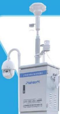
β射线法和光散射法同时测量颗粒物浓度 (PM2.5/PM10/TSP)，通过β射线法数据对光散射系统定期校准，监测数据以分钟值输出；具备多种通讯模式，可远程查询仪器工作状态和实时测量数据；内置动态数据存储功能，存储3年，支持数据导出；可选配各种参数IP摄像头，保证夜间和视距拍摄要求，可自动抓拍，也可供用户实时查看
