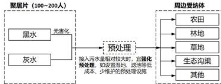
图4 聚居片（常住人口100~200人或污水产生量为10~20m 3 /d）模式示意图
