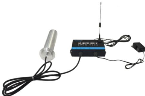
ZWIN-YY06 油烟数据采集器，由采集器主体和油烟探头 2 部分组成。采集器集成 GPRS 无线通信模块（可选 CDMA），采用实时在线、自动上报的方式工作。采集器带有油烟探头专用接口，用于连接探头。采集器通过控制探头采集油烟原始数据，读取探头采集到的原始数据，并进行综合计算，最终得到油烟浓度值。
