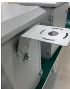
2) 将风速传感器线五芯插头的一端插在风速传感器上，另一端穿过支架中间孔洞，用螺丝螺母将风速传感器安装在主机左侧支架上，最后将传感器线另一端插头插在主机左侧航空插头上。
