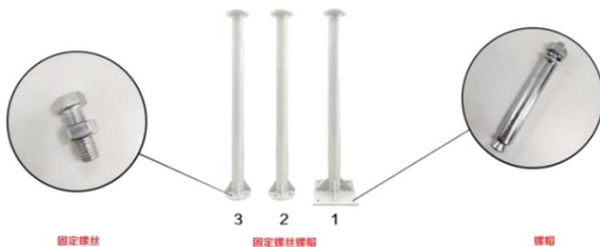
立杆整体安装按照图示 1、2、3 的顺序（1-底部，2-中间部分，3-顶部）安装，每段连接处使用图左侧所示固定螺丝固定，底部使用图右侧所示螺帽固定。
