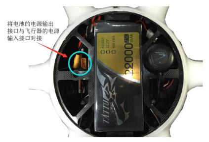
将飞行器电池按如图所示方向,放入电池仓,插好电源接头,重新 盖好电池仓盖即可完成飞行器主机的安装。此时飞行器处于待机状 态,等待遥控器或者地面站的飞行指令。
