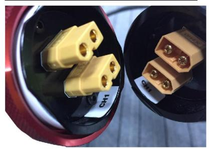
机臂的安装:请留意机臂接口处的编号,应与飞行器机臂接口处的编号相对应,如"CH1"应与"CH1"对接。
