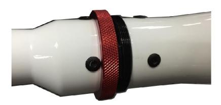
接口插紧以后,将法兰环顺时针拧紧即可完成机臂的安装。六个机臂安装方法相同。
