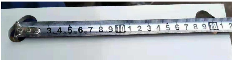
立杆底座孔间距尺寸测量图
