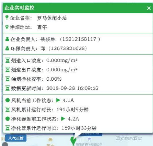
单机相应点位水滴标志，能在地图上弹出监测点位一览表，准确显示监控点位的名称、位置、企业负责人、环保负责人、烟道出入口浓度、油烟净化效率、风机和净化器工作状态及运行时长等信息。风机和净化器对应标志为绿色代表处于开启状态，为红色代表处于关闭状态。
