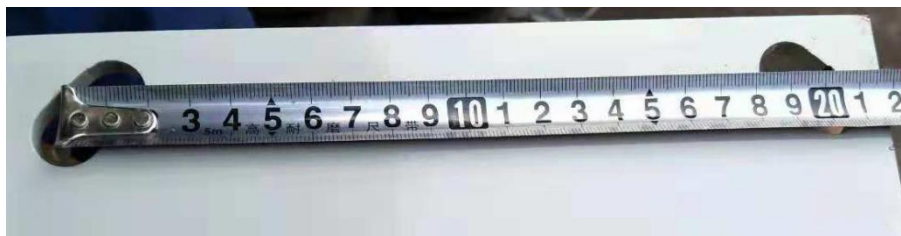
立杆底座孔间距尺寸测量图
